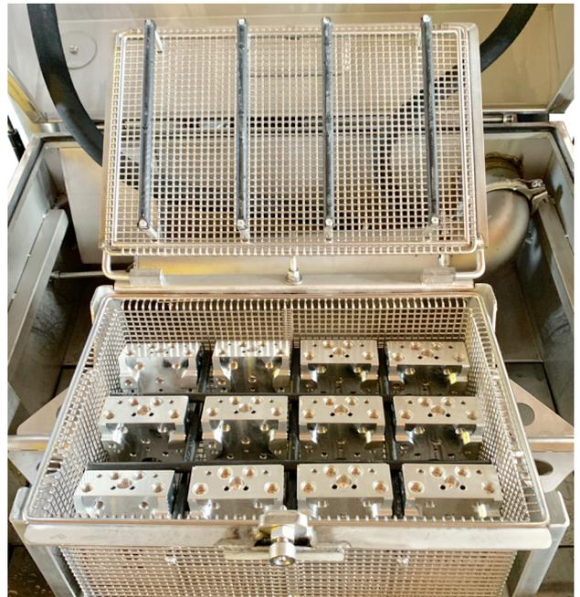
Beispielbild: Reinigung von Aluminium Pumpengehäusen
